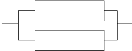
Figure 2: Varmennus passivisella redundanssilla
